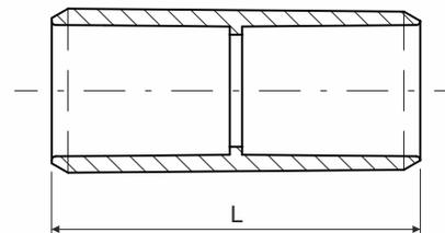
Produktbeschreibung: raucharme, halogenfreie Muffen, konzipiert für die Verbindung flexibler Rohre
