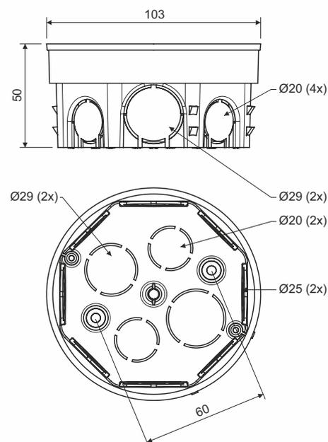
Produktbeschreibung: geeignet für Leitungen mit einer Spannung bis 400 V und Stromstärke bis max. 16 A
