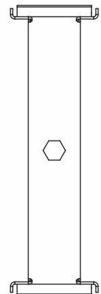
**Produktbeschreibung:** Die Auflistung dient zur Befestigung der Kabelrinne oder Kabelleiter mittels Gewindestange.
