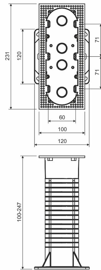
Produktbeschreibung: geeignet für Leitungen mit einer Spannung bis 400 V
