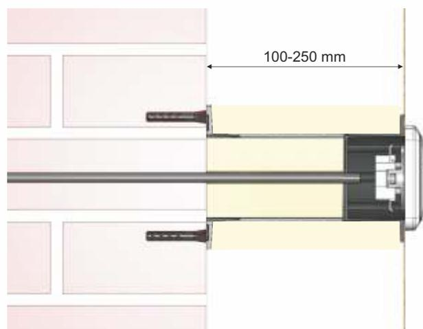
Vor der Montage ist die Halterung inkl. beigelegter Isolierung auf die benötigte Länge, entsprechend der Wärmedämmungsstärke zu kürzen.
