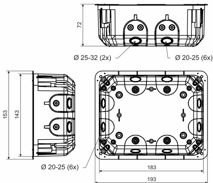
Produktbeschreibung: geeignet für Leitungen mit einer Spannung bis 500 V und Stromstärke bis max. 16 A
