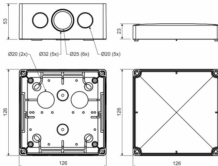
Produktbeschreibung: geeignet für Leitungen mit einer Spannung bis 1000 V
