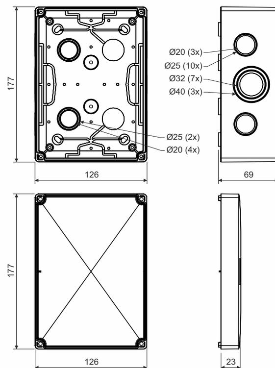
**Produktbeschreibung:** geeignet für Leitungen mit einer Spannung bis 1000 V
